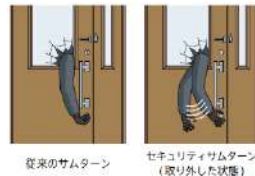
従来のサムターン セキュリティーサムターン (取り外した状態)
